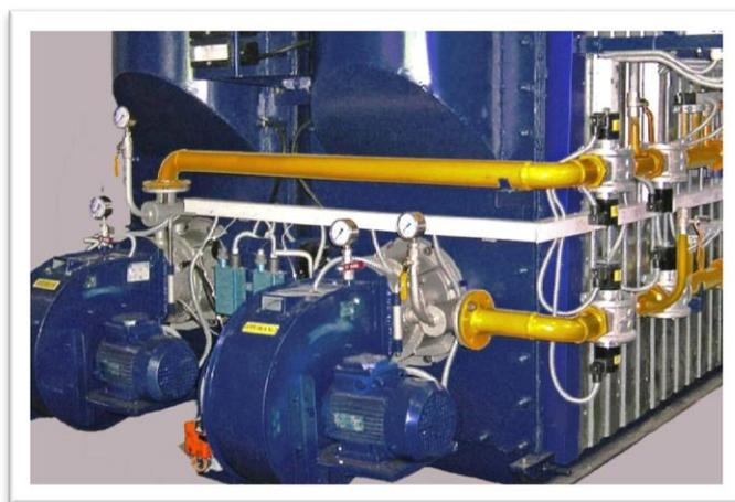
Блочные газовые горелки ГСАУ-Б (блочные), изготавливаются на базе горелок ГСАУ.
